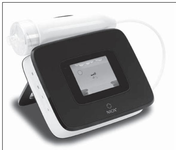
写真1 呼吸一酸化窒素濃度計測器
