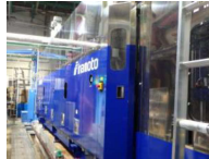
連続式洗濯機 1槽あたりの負荷量：60kg 処理能力 1500kg/h (負荷量60kg)
