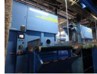
乾燥機 食荷容量：120kg 蒸気消費量：132kg/回 (528kg/hr)
