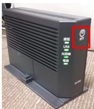
回線終端装置（ONU） NTTマークが付いています。
