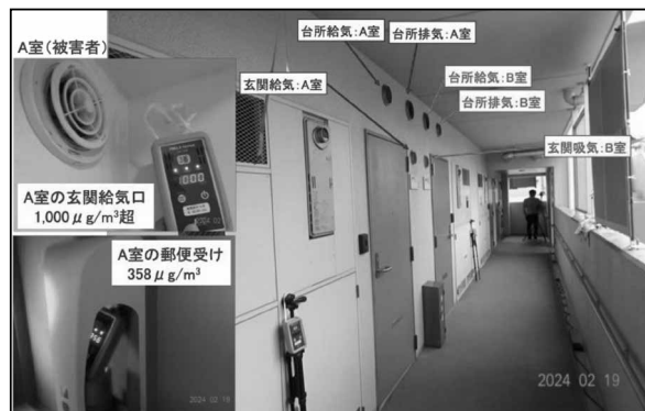
図11 台所換気扇→共用廊下→隣家への被害
